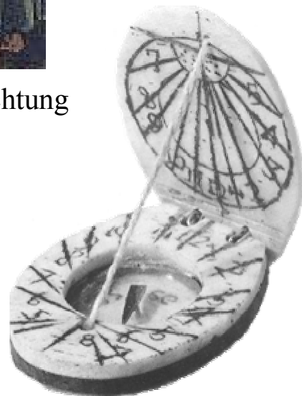
b) Rekonstruktion einer Klappsonnenuhr mit Kompass und Schattenwerferfaden
